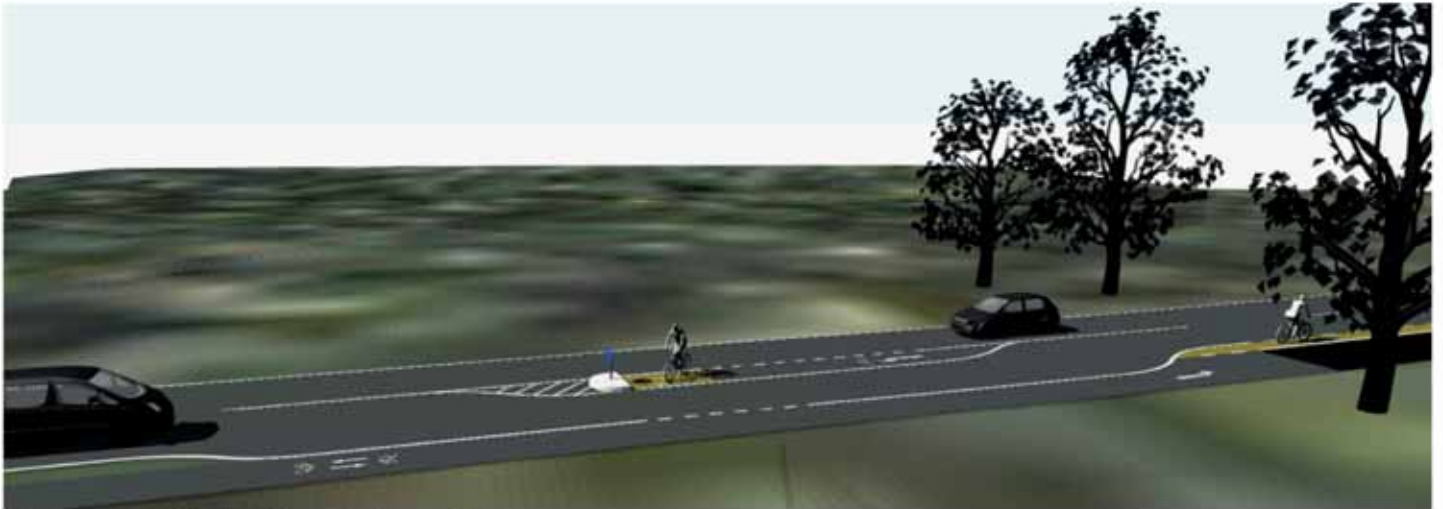
Abbildung: Beispiel für Überführung Radweg - Fahrbahnseite
